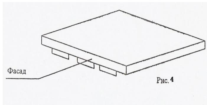
**Панель фасадная (3 шт.).** Соединяет между собой боковые стенки и перегородки. Устанавливается в нижней части шкафа (рис.5).
