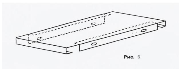
**Полка.** Кроме уголков, приваренных с боков, имеются еще два уголка с продолговатыми отверстиями для крепления к боковым стенкам (рис. 7).
